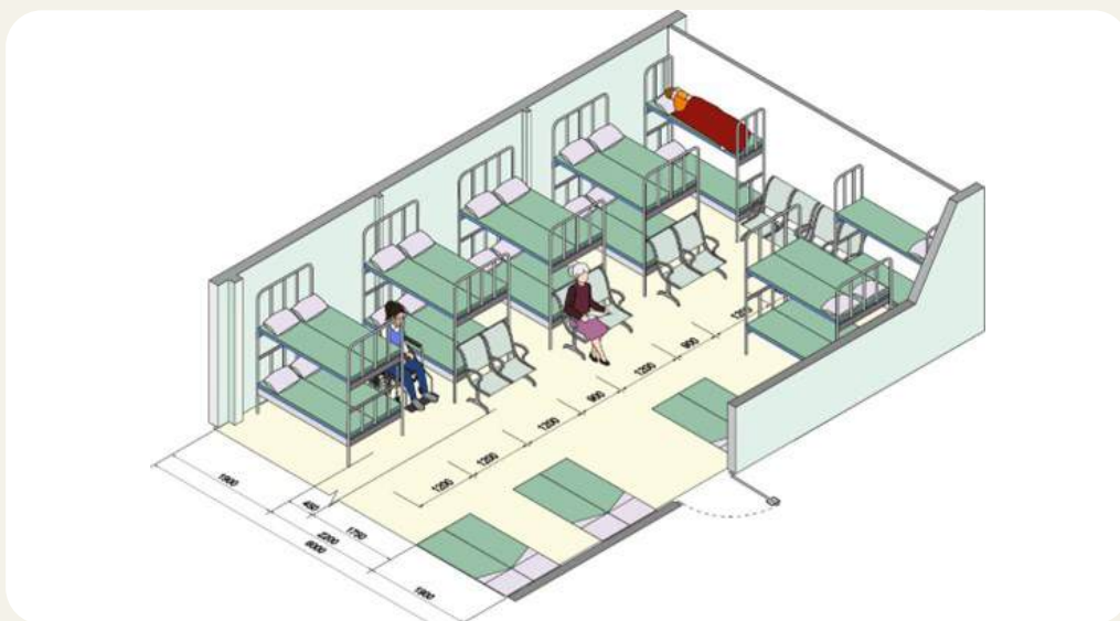
Рисунок 2.6. Схема облаштування укриття житлового будинку
